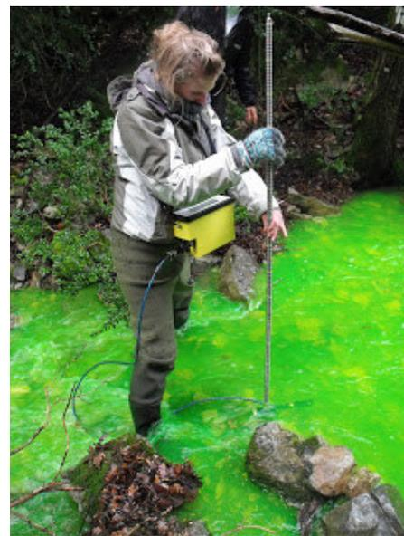
Mesures de débit au courantomètre
